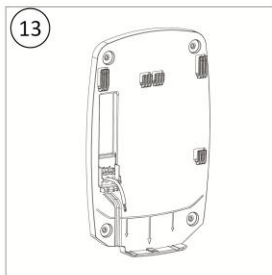
13 Enrutar los cables a través de la base Plug in según muestra la imagen
