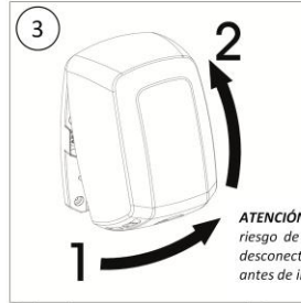
3 Quitar la carcasa con un movimiento rotativo
