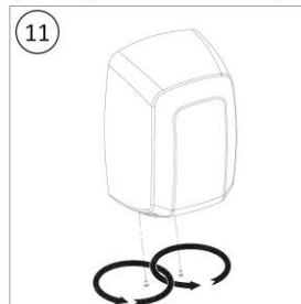
11 Colocar los tornillos de fijación de la carcasa (x2)
